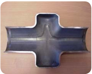
Deformazione della saldatura (1.4003).
