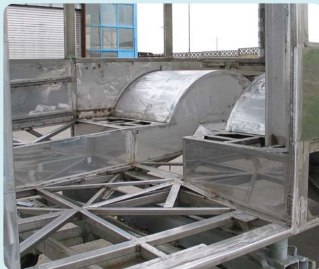
Telaio strutturale in 1.4003.
