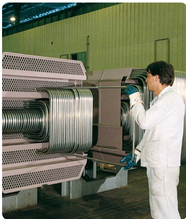
Separatore di umidità del riscaldatore, tipo 439, Europa.
